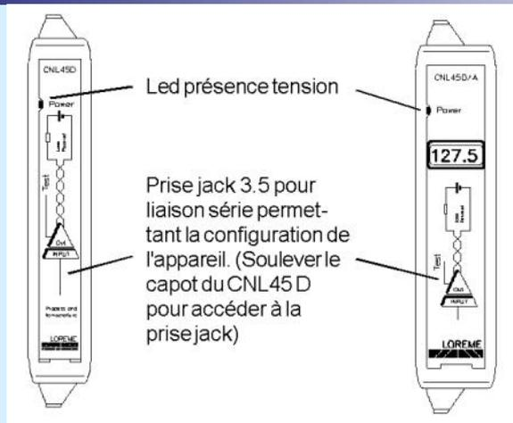
L'objet de ce manuel de configuration est de se familiariser avec les fonctions offertes par l'appareil. Le CNL 45D est un convertisseur en technique 2 fils, alimenté par la boucle de courant. De part sa constitution, il ne dispose donc que de deux fils pour l'alimentation et la sortie analogique. Ses capacités d'entrées sont les suivantes: mV, V, mA, résistance (2 ou 3 fils), Pt100 (2 ou 3 fils), Tc (B, E, J, K, R; S, T) et potentiomètre.
